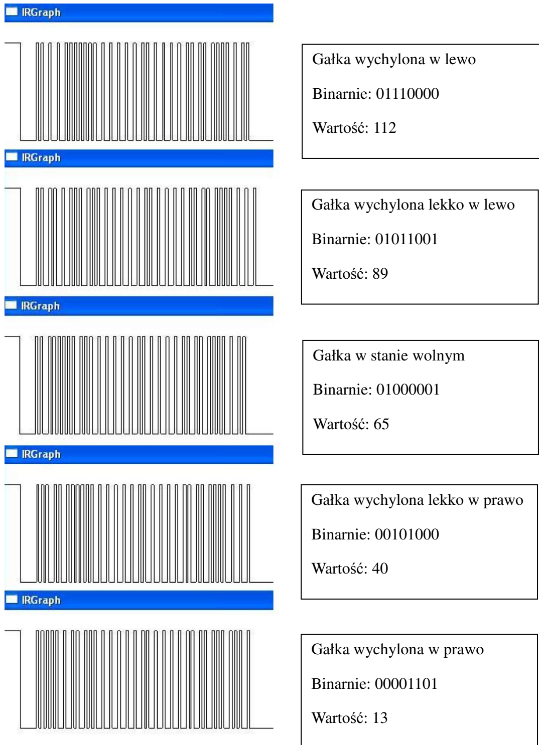
Rysunek 5.9 - Graficzna ilustracja sygnału ze zmiennym wychyleniem poziomym gałki prawej
