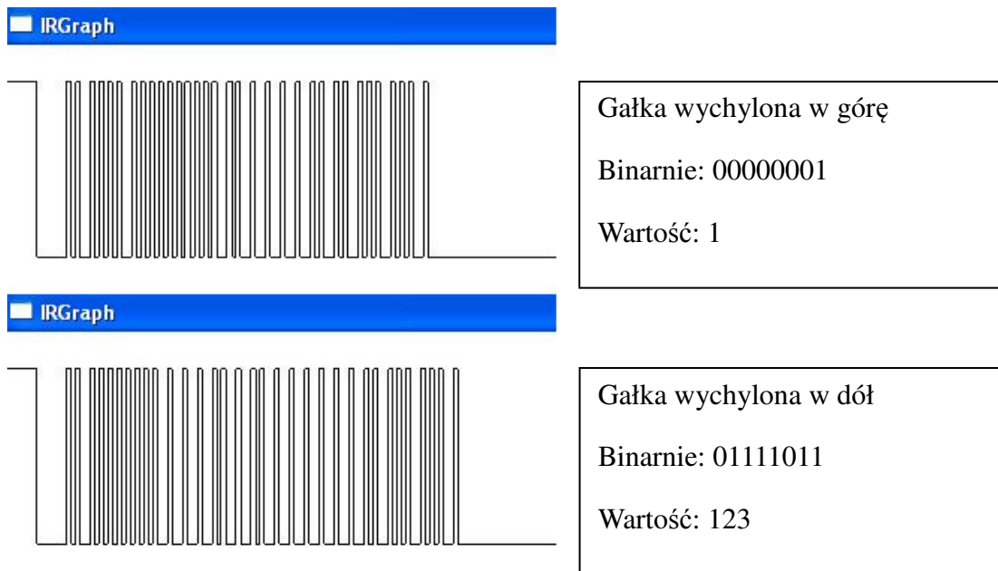
Rysunek 5.10 - Graficzna ilustracja sygnału ze zmiennym wychyleniem pionowym gałki prawej
